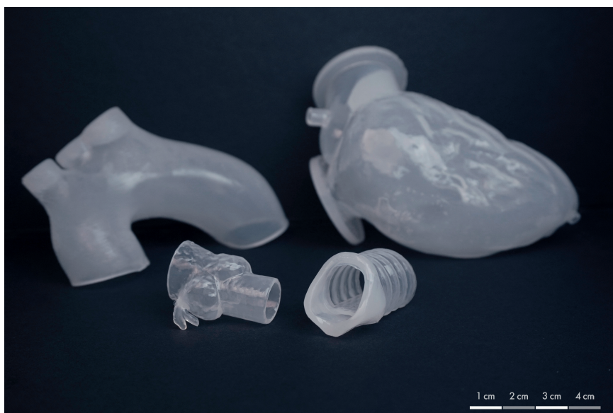
Beispielanwendungen: 3D-gedruckte anatomische Modelle aus Silikon. © Spectroplast
